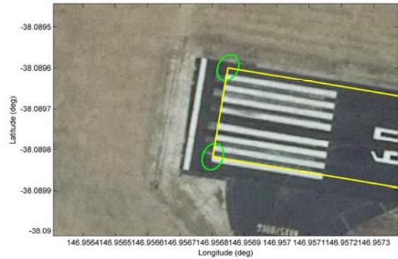
FIG. 19. RUNWAY POSITIONING SOLUTION FOR SIMULATED EXPANDED FLIGHT EXTENTS (09 RUNWAY END).
