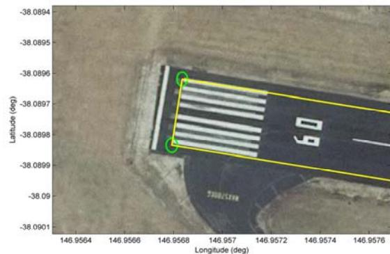
FIG. 33. RUNWAY POSITION SOLUTION DURING FLIGHT TEST (09 RUNWAY END).
