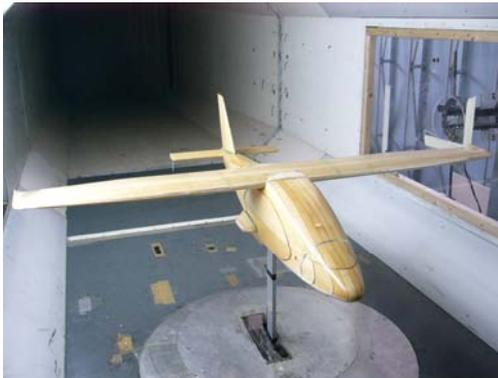
Fig. 12. P2006T Wind-Tunnel Model
