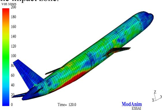
Figure 14 : Von Mises Strength (Crash)
