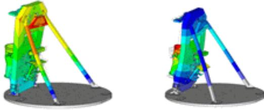
(a) 1<sup>st</sup> Mode (Rotation)      (b) 2<sup>nd</sup> Mode (Bending)
