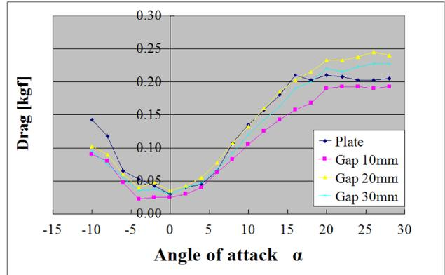
Fig. 9. Drag vs.  $\alpha$  ( $V=15\text{m/s}$ )
