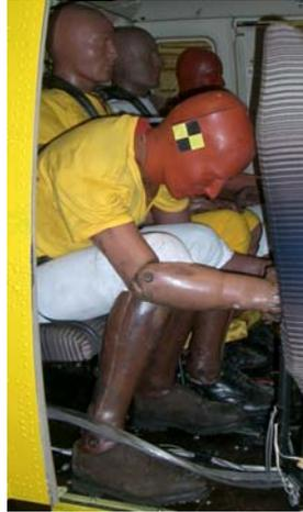
Fig. 15. JAXA Shock Absorbing Device Seat Fig. 16. Brace Position
