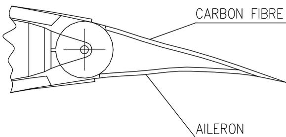
Fig.10 Trailing edge in aileron area
